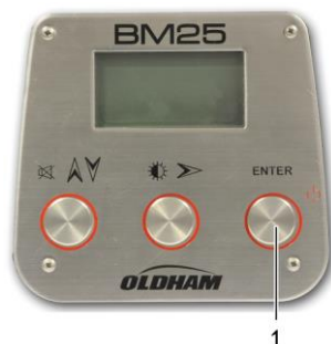
Figure 19 : mise à l'arrêt par appui sur la touche Enter
