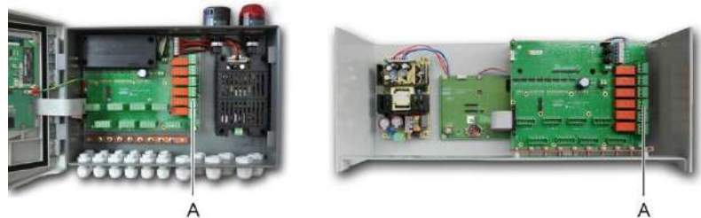
Figure 34 : connecteurs des relais d'alarme internes (rep. A).
