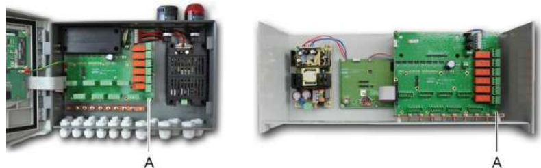
Figure 35 : connexion de l'acquit à distance (rep. A).
