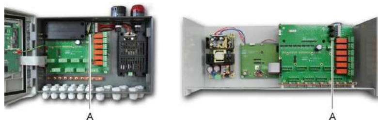
Figure 29 : connexion de l'alimentation externe 24 V DC (rep. A).
