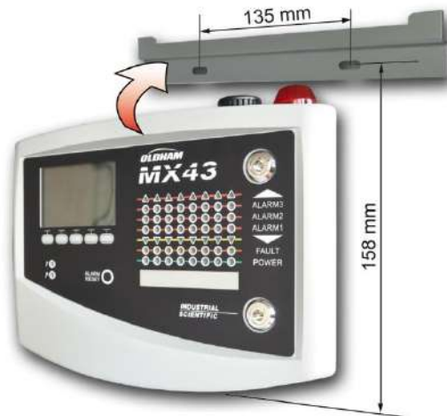
Figure 5 : fixation de la MX 43 en version murale avec la platine support.
