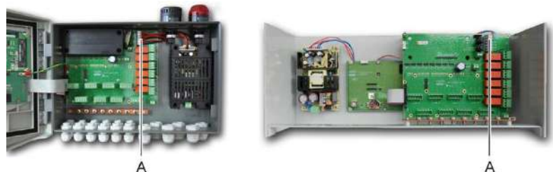
Figure 37 : localisation du connecteur pour flash et hurleur (rep. A).
